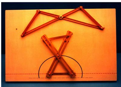
L'ellissografo è costituito da un antiparallelogramma articolato  $ABCD$  di cui uno dei due lati minori,  $AB$ , è fissato al piano del modello. Facendo ruotare l'asta  $AD$ , i punti  $C$  e  $D$  percorrono le circonferenze aventi centro, rispettivamente, in  $A$  e  $B$ . I lati  $AD$  e  $BC$  dell'antiparallelogramma, si incontrano in  $P$ .
