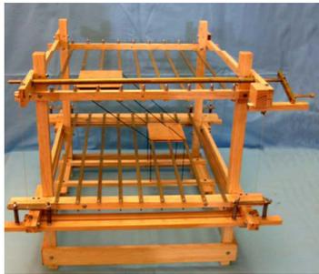
I piani di plexiglas sono stati sostituiti con dei piani rigati che permettono l'esplorazione tattile. I fili mantenuti in tensione da pesi sono stati sostituiti da elastic, di diametro maggiore e che rimangono più tesi. Le figure disegnate sono state sostituite con figure rettangolari in legno.
