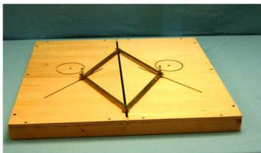
La guida è sostituita da una scanatura nel legno. Il punto tracciatore e il punto direttore possono scorrere in due circonferenze o in due segmenti incisi nel legno.
