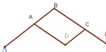
La macchina per la realizzazione di una omotetia, *pantografo di Scheiner*, è formata da quattro aste rigide incerniate nei punti  $A, B, C$  e  $D$  scelti in modo da formare una parallelogramma articolato. Il sistema è imperniato in  $O$  al piano del modello. Il punto  $P$  sull'asta  $BC$  è scelto in modo tale che sia  $\frac{BP}{BC} = \frac{OB}{OA} = k$  ( $k$  è la costante dell'omotetia).
