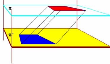
La macchina per la genesi spaziale di una traslazione è costituita da due lastre rettangolari in plexiglas che rappresentano due piani paralleli  $\pi$  e  $\pi'$ . Il meccanismo permette di sovrapporre i due piani con un moto continuo, mantenendoli paralleli e senza ruotarli uno rispetto all'altro: durante tale movimento anche i fili tesi (raggi) conservano il loro parallelismo.
