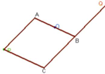
La macchina per la realizzazione di una simmetria centrale è formata da un rombo  $ABCP$  articolato, il cui lato  $AB$  è imperniato al piano del modello nel suo punto medio  $O$ . L'asta  $CB$  è prolungata di una lunghezza  $\overline{BQ} = \overline{CB}$ . I punti  $P$  e  $Q$  hanno due gradi di libertà e sono rispettivamente il punto direttore e il punto tracciatore
